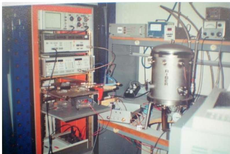
Laboratoire de tests des détecteurs hétérodynes sous vide et refroidis vers 20 kelvin (Meudon, années 1975-85)
